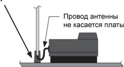
Устанавливайте крепление трубки антенны как можно ближе к приемнику. Избыток антенного провода до крепления антенны подвержен помехам.
