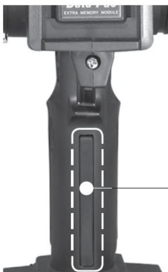
Виброзвонок встроен в рукоятку ТЗРКС. Виброзвонок может включаться таймером навигации кругов, таймером прямого отсчета и сигналом низкого напряжения батареи.
