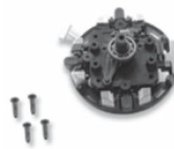
Винты крепления узла (4)
