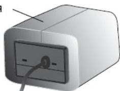
Оберните приемник в микропористую резину или в другой вибропоглощающий материал. Не используйте жесткий материал. Жесткий материал не имеет вибропоглощающего эффекта.
